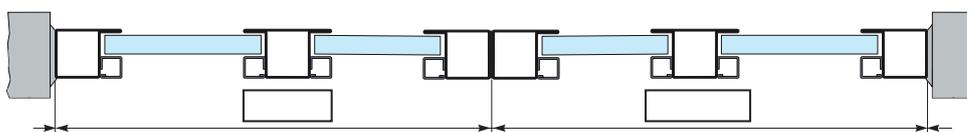
Telaio inferiore a "L" con telaio a "Z" su 3 lati     Telaio inferiore a "L" con telaio a "T" su 3 lati
