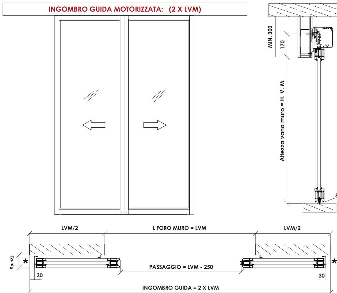
\* sensore di protezione obbligatorio se la distanza dall'anta al muro perpendicolare è < 200 mm
