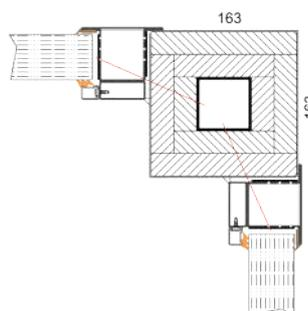
L'esigenza di installazione dei serramenti tagliafuoco su varie tipologie di supporto ha portato a sviluppare degli elementi strutturali e modulari per soddisfare le varie necessità di cantiere.
