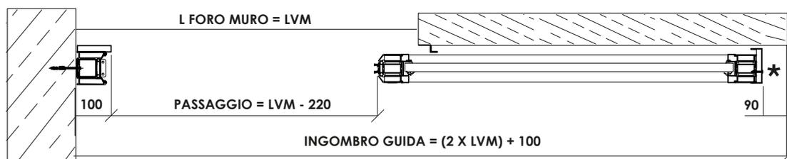
\* sensore di protezione obbligatorio se la distanza dall'anta al muro perpendicolare è < 200 mm
