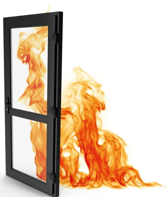
Le **porte tagliafuoco VITREX F6 e VITREX F7** sono realizzati in tubolare d'acciaio profilato con alette di battuta. Sono dotati di lastre isolanti a base di calciosilicati e guarnizioni autoespandenti per fumi caldi perimetrali, oltre a guarnizioni di battuta per fumi freddi. La struttura consente diverse configurazioni di montaggio grazie all'accoppiamento delle sezioni Z, L, T.
