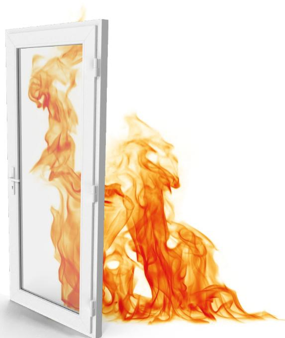
Le **porte tagliafuoco VITREX F6 PLUS** sono realizzati in tubolare d'acciaio profilato con alette di battuta. Sono dotati di lastre isolanti a base di calciosilicati e guarnizioni autoespandenti per fumi caldi perimetrali, oltre a guarnizioni di battuta per fumi freddi. La struttura consente diverse configurazioni di montaggio grazie all'accoppiamento delle sezioni Z e L, con uno spessore di 60 mm per le ante e 80 mm per il telaio maggiorato.
