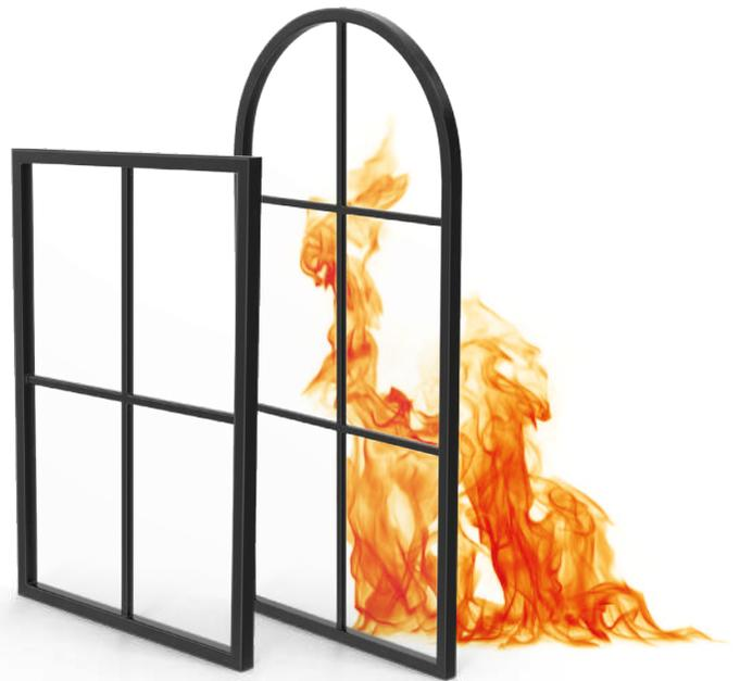
Le **vetrate fisse tagliafuoco VITREX F5 e VITREX F1.1** sono realizzate in tubolare d'acciaio profilato con allette di battuta. Sono dotate di lastre isolanti a base di calciosilicati e guarnizioni autoespandenti per fumi caldi perimetrali. La struttura ha uno spessore totale di 60 mm per i serramenti EI<sub>2</sub>30/60 e 80 mm per i serramenti EI<sub>2</sub>90/120.
