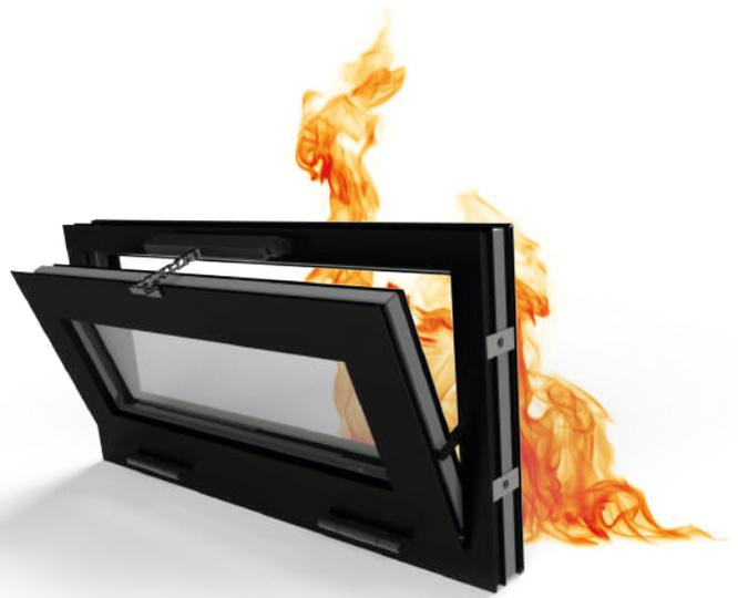
Le **finestre Vasistas tagliafuoco ALU R3** sono realizzate con profili in estruso di alluminio, in lega EN AW6060, opportunamente trafilati. Completati con guarnizioni di battuta fumi freddi e guarnizioni autoespandenti perimetrali per fumi caldi. La struttura ha uno spessore totale di 72 mm per i serramenti EI<sub>2</sub>30/60 ed 81 mm per i serramenti EI<sub>2</sub>90.
