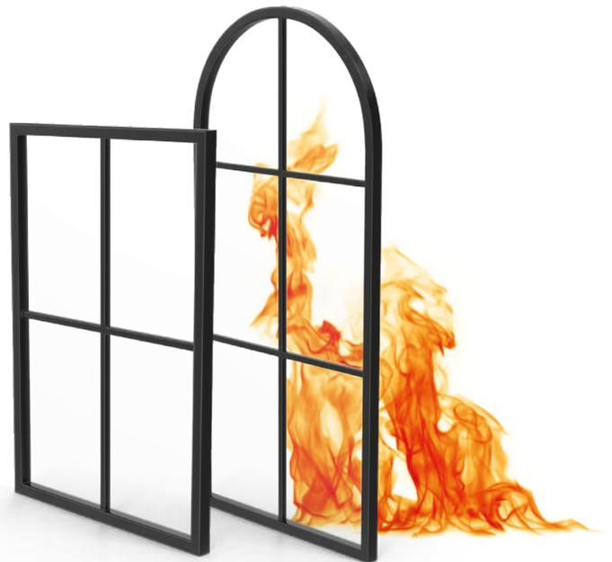
Le **vetrate fisse tagliafuoco ALU GLASS R7, R4, R4+, R8** sono realizzate con profili in estruso di alluminio, in lega EN AW6060, opportunamente trafilati. Completati con guarnizioni fumi caldi autoespandenti perimetrali. All'interno, sono presenti lastre isolanti a base di calciosilicati che forniscono una protezione eccellente. La struttura ha uno spessore totale di 72 mm per i serramenti EI<sub>2</sub>30/60 e 89 mm per i serramenti EI<sub>2</sub>90/120.
