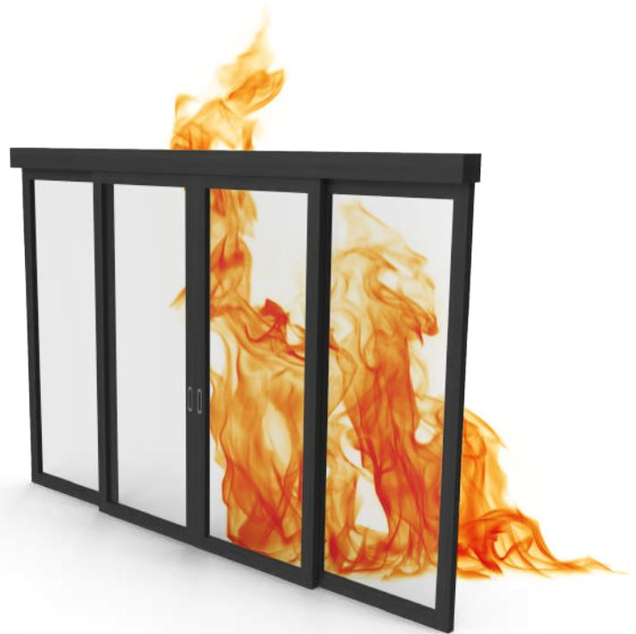
Le **porte scorrevoli tagliafuoco VITREX F13** sono realizzate con un telaio portante in tubolare d'acciaio profilato zincato con uno spessore di 15/10, e sono rivestite da una copertura in estruso di alluminio trafilato in lega UNI 6060. All'interno, sono presenti lastre isolanti a base di calciosilicati.
