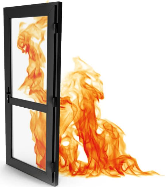
Le **porte tagliafuoco VITREX F6 e VITREX F7** sono realizzati in tubolare d'acciaio profilato con alette di battuta. Sono dotati di lastre isolanti a base di calciosilicati e guarnizioni autoespandenti per fumi caldi perimetrali, oltre a guarnizioni di battuta per fumi freddi. La struttura consente diverse configurazioni di montaggio grazie all'accoppiamento delle sezioni Z, L, T.
