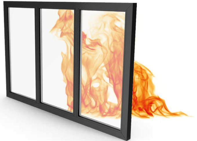
Le **vetrate fisse tagliafuoco VITREX F2 e VITREX F3** sono realizzate con un telaio portante in tubolare d'acciaio profilato zincato con uno spessore di 15/10, e sono rivestite da una copertura in estruso di alluminio trafilato in lega UNI 6060. All'interno, sono presenti lastre isolanti a base di calciosilicati che forniscono una protezione termica eccellente. La struttura ha uno spessore totale di 79 mm per i serramenti EI<sub>2</sub>30/60 e 94/104 mm per i serramenti EI<sub>2</sub>90/120.
